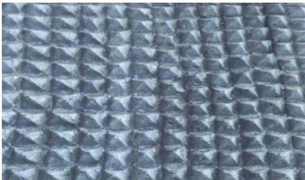
Рис. 6. Внешний вид акустической графитовой панели
